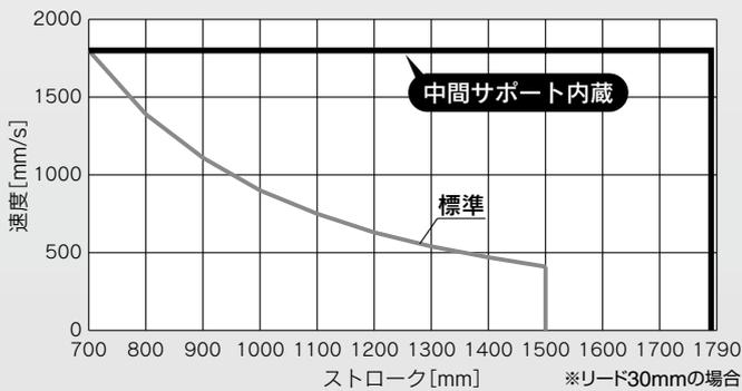
中間サポートによりロングストローク時のボールねじのたわみを低減
