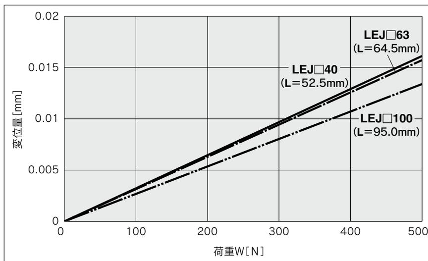
注) アルミ板厚15mmをテーブル上面に固定し測定した時の値です。(テーブルガタ含む)
