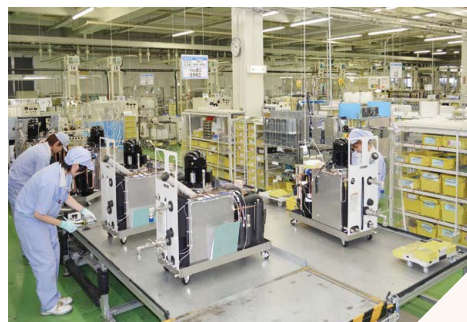
温調機器 組立・検査
