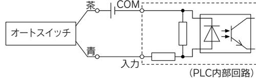
PLCの入力仕様により接続方法が異なりますので、PLCの入力仕様に応じて接続してください。
