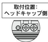
詳細図F:前進端アジャストブロック取付位置
