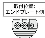
詳細図F:前進端アジャストブロック取付位置
