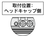
詳細図C:前進端アジャストブロック取付位置
