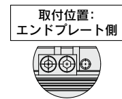
詳細図C:前進端アジャストブロック取付位置
