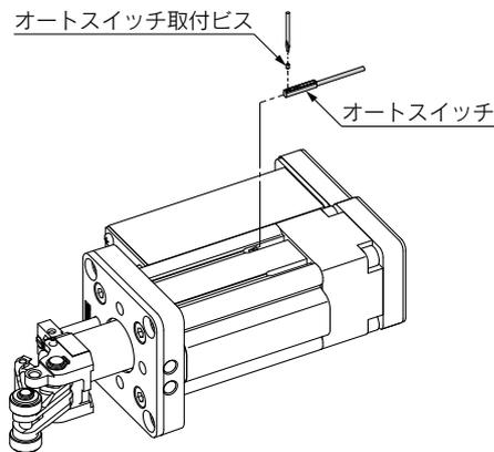
・オートスイッチ取付ビスを締付ける際には、握り径5~6mmの時計ドライバを使用してください。
