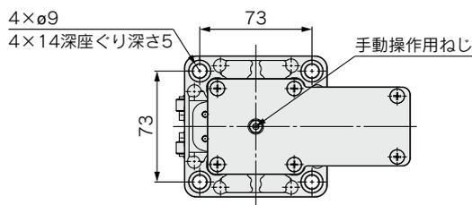
注1) 上部(レバー側)から取付ける時はレバーと取付板との干渉に注意し、板厚10mm以下にしてください。
