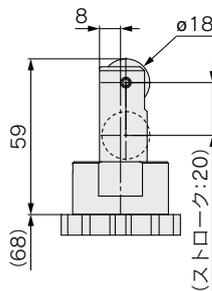
図2.ロッド先端形状
