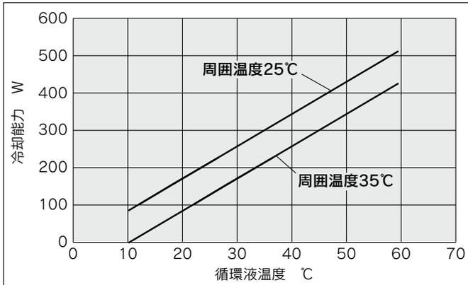
循環液：水、流量：1L/min、ファン一定モード選択時
