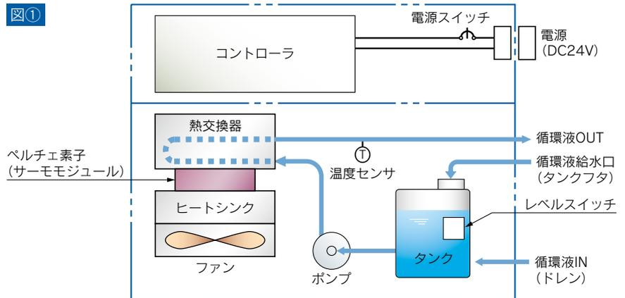
サーモコンは図①の構造になっています。ペルチェ素子(サーモモジュール)を熱交換器とヒートシンクの間にはさみ、供給するDC電源を制御して循環液の出口温度を高精度に制御します。循環液はタンクに戻り、ポンプによって圧送され、熱交換器、温度センサを経由してOUTから放出されます。
