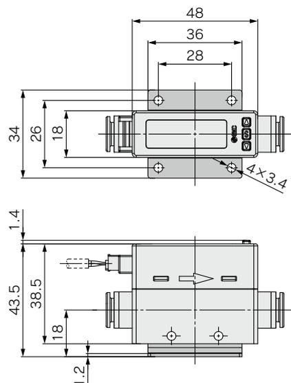
パネルマウントアダプタ／流量調整弁なし
