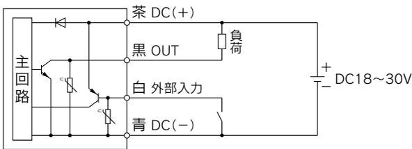
最大印加電圧: 30V、最大負荷電流: 80mA、内部降下電圧: 1.5V以下
