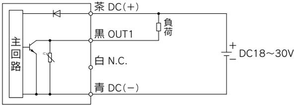
最大印加電圧: 30V、最大負荷電流: 80mA、内部降下電圧: 1.5V以下
