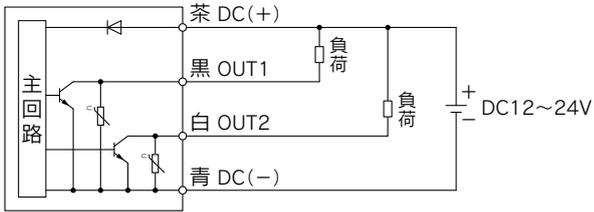
最大印加電圧: 28V、最大負荷電流: 80mA、内部降下電圧: 1V以下
