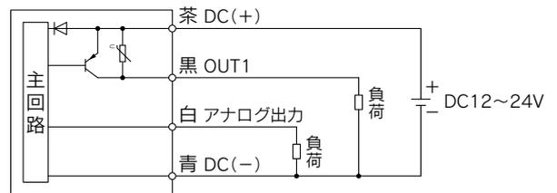
最大負荷電流: 80mA、内部降下電圧: 1.5V以下
