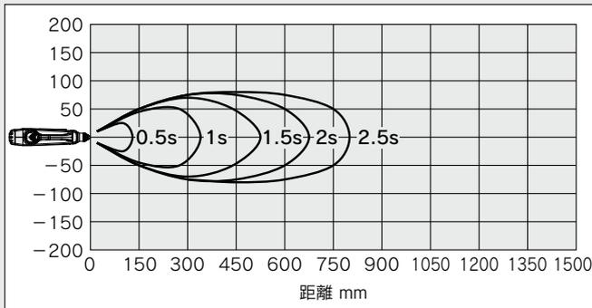
2) 供給圧力0.1MPa 消費流量119L/min(ANR)
