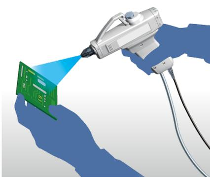
上から吊り下げての小型樹脂部品の除電・除塵
