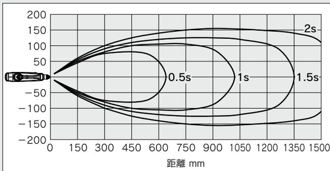
6) 供給圧力0.5MPa 消費流量390L/min(ANR)
