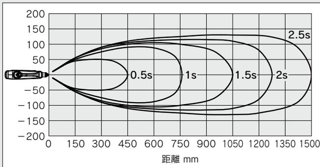
4) 供給圧力0.3MPa 消費流量253L/min(ANR)
