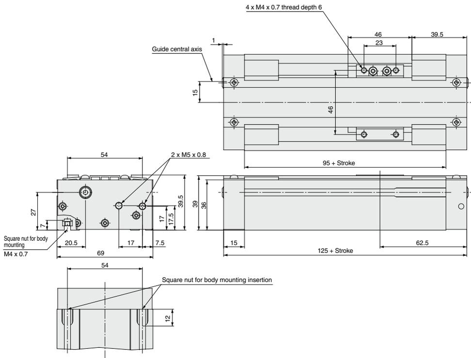
Dimensions:  $\varnothing 15$ ,  $\varnothing 20$ ,  $\varnothing 25$
