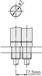
注) 取付けはシリンダ取付ねじを利用し直付け
