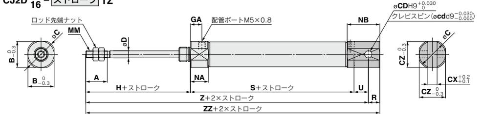
※クレスピス用ピンと止め輪が同梱されます。
