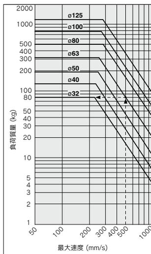
例) φ63のエアシリンダを最大速度500mm/sで動かすときのロッド先端負荷制限を求める。グラフの横軸500mm/sより上に延長しチューブ内径63mmのラインとの交点を左に延長し負荷80kgが求められます。
