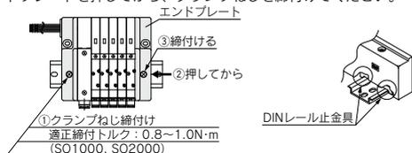
DINレールの止金具がDINレールに確実に引掛っているかご確認ください。
