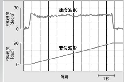
測定条件 / 作動流体: 空気、取付姿勢: 軸垂直無負荷、使用圧力: 0.5MPa
