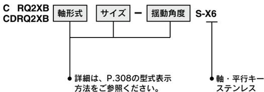
錆の発生や腐食の恐れのある場所に使用する際に、標準部品の材質の一部をステンレス鋼に変更。
